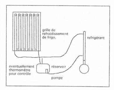
Le système fonctionne à la perfection et les mesures d'écoulement ont donné 12-16 litres par heure, ce qui est très suffisant pour que le liquide de refroidissement soit toujours à une température inférieure à 30°, lorsque les vapeurs dans la colonne sont de l'ordre de 100°.
